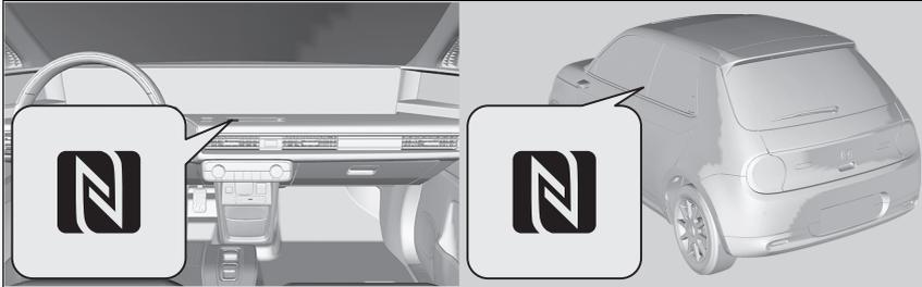
Pour les véhicules à conduite à droite, les marqueurs NFC se trouvent directement à l'opposé de ceux des véhicules à conduite à gauche.
