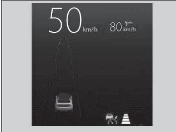
Votre véhicule reste à la vitesse réglée sans maintien du pied sur la pédale de frein ou d'accélérateur. Si auparavant, un véhicule détecté devant vous empêchait votre véhicule de rouler à la vitesse réglée, l'ACC avec maintien de distance de sécurité à basse vitesse fait accélérer votre véhicule jusqu'à la vitesse programmée, puis maintient cette vitesse.
