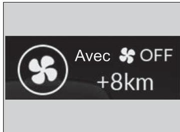
Il est possible d'augmenter l'autonomie de conduite en désactivant le système de commande de la climatisation. La distance affichée sous **Avec**
