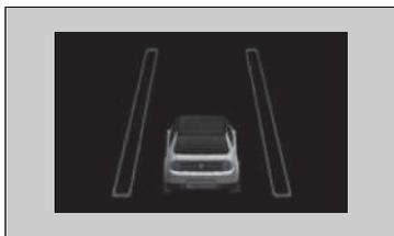
Lorsque le système d'assistance au maintien dans la voie de circulation (LKAS) est suspendu, les lignes de délimitation des voies se changent en lignes d'encadrement sur la jauge et le signal sonore retentit (s'il a été activé).
